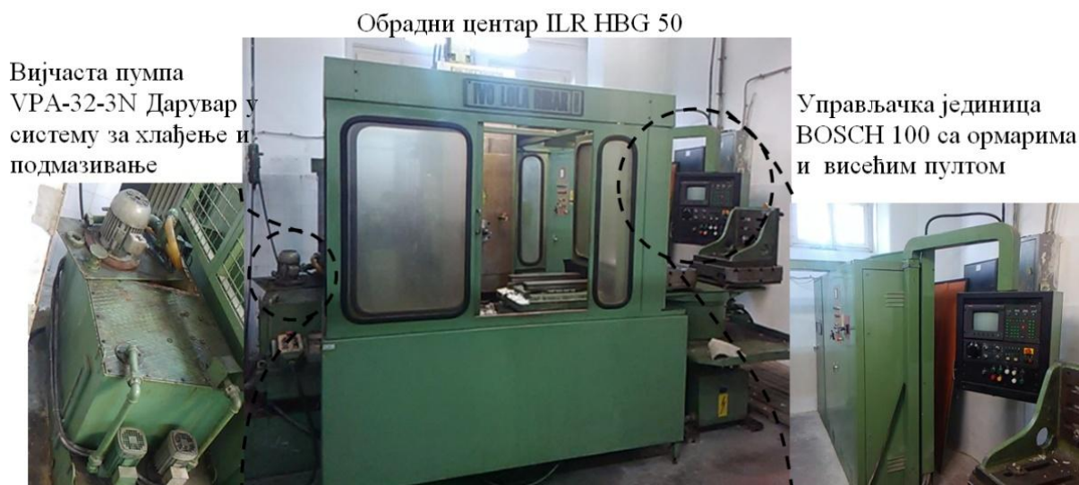
Слика 1. Обрадни центар ILR НВГ50 ОС са приказом постојеће управљачке јединице BOSCH CC 100 и вијчастом пумпом.
